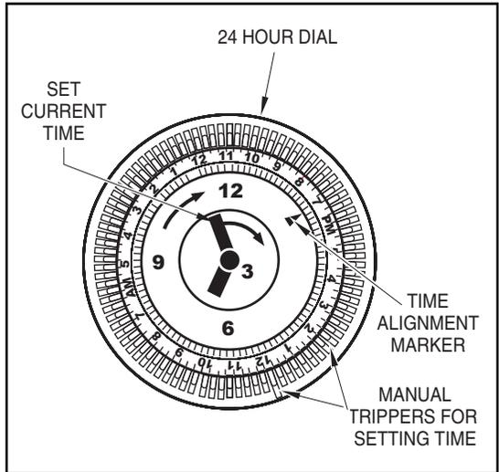
**FIGURE 3: 2018 DEFROST TIMER CLOCK LOCATED IN ELECTRICAL CONTROL PANEL ON TOP OF WALK-IN**
